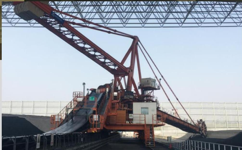
中电国际普安电厂2台堆取料机进行无人值守改造，完成建设并投入使用，目前已基本实现其设计功能，效果显著：
